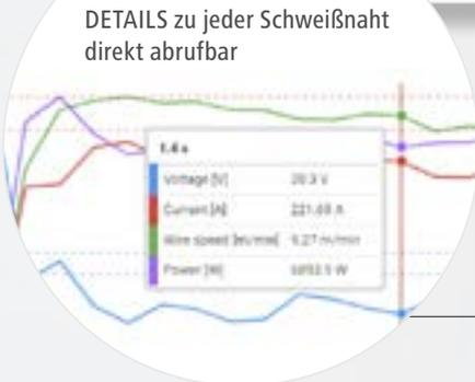
Soll- und Istwerte sowie Grenzwertverletzungen und Verbrauchswerte werden pro Naht dokumentiert und aufbereitet
