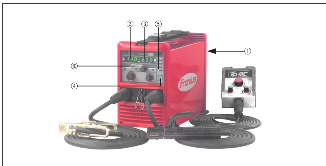
III. 21 Il Transtig 1600 / 1700 è un impianto di saldatura manuale E composto da: fonte elettrica con unità di comando, regolatore a distanza manuale TPmc (a scelta) e cavi di saldatura
