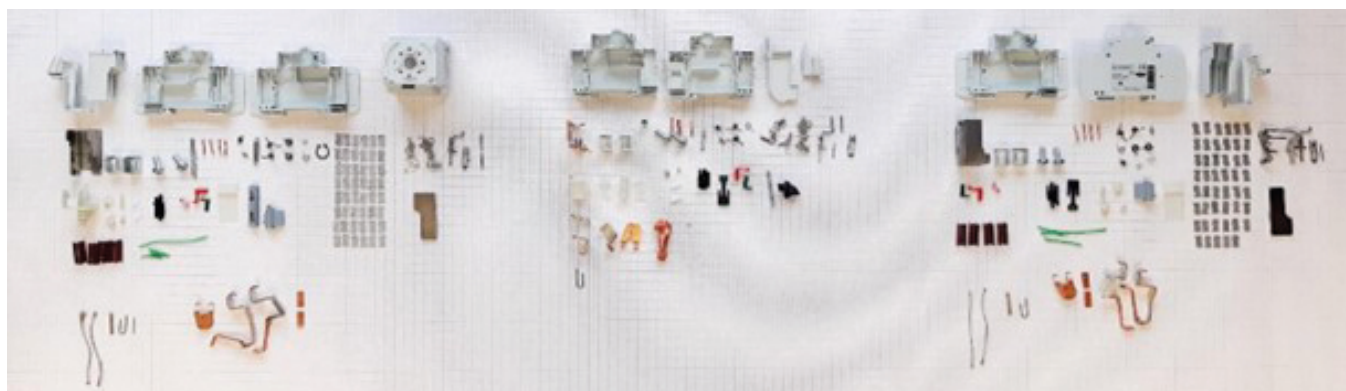
Zdjęcie 1: Szczegółowy demontaż odłącznika DC w Tauro ECO na potrzeby dalszego modelowania oceny LCA
